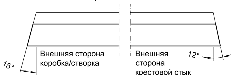
Внутренняя сторона коробка/створка Угол \alpha зависит от применяемого штапика (см. указания по остеклению).
